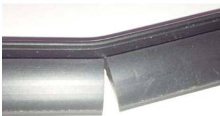
Abb1. Schnitt in der Keildichtung zur Eckausbildung
