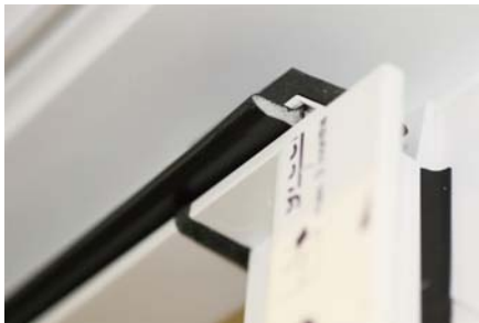
Abb. 4 Einziehen der Dichtung G045.1 bis in die Endkappe des Mittelverschlusses
