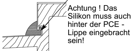
Abb.1 Abdichten auf ganzer Breite des Zargendichtblocks 9S69
