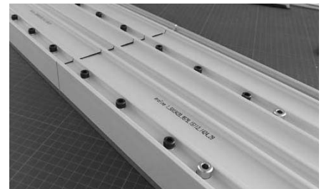
14. Schwellenteil 2 Mit Zylinderkopfschrauben M6x16 und Unterlegscheibe die Schwelle am Profil verschrauben. Schrauben fest anziehen.
