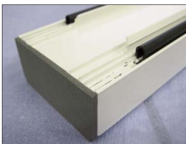
Abb. 2 Dichtpad M434 auf Zwischenprofil geklebt, Dichtungen und Klipsfüße entfernt.
