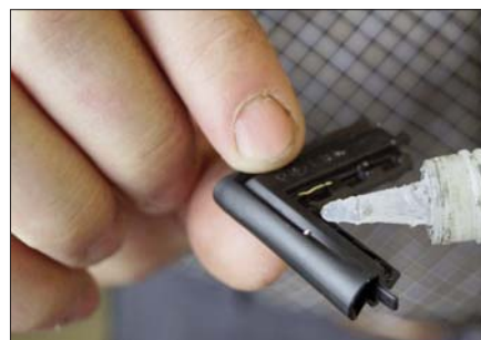
Abb. 4 Vorbereitung Kleben an die Flügelecke
