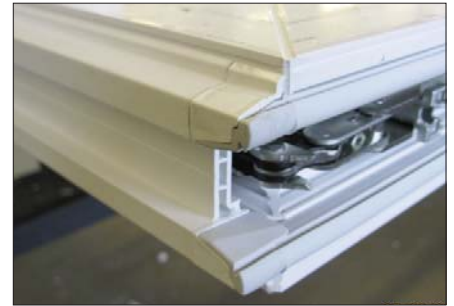
Abb. 2 Flügel unten G152 an M439R/L kleben
