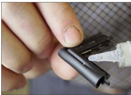
Abb. 1 Vorbereitung Kleben an die Flügelecke
