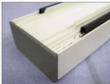
Abb. 2 Dichtpad M434 auf Zwischenprofil geklebt, Dichtungen und Klipsfüsse entfernt.
