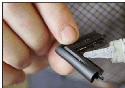
Abb. 4 Vorbereitung Kleben an die Flügelecke
