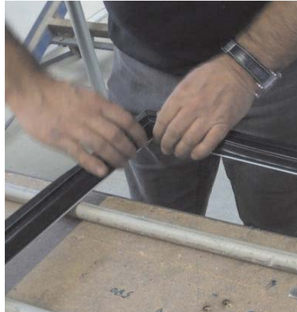
Einsetzen des Dichtblocks
